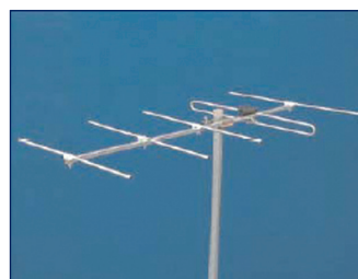
LA 115 on korkealuokkainen 5-elementtinen antenni ULA-alueelle. Se on valmistettu ontosta alumiiniprofiilista, mikä mahdollistaa keveän ja lujan rakenteen. Antenni on kauttaaltaan korroosiosuojattu.
